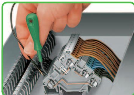
Inserção do condutor usando uma chave de fenda angular (3,5 x 0,5) mm/(0,137 x 0,020) pol.
