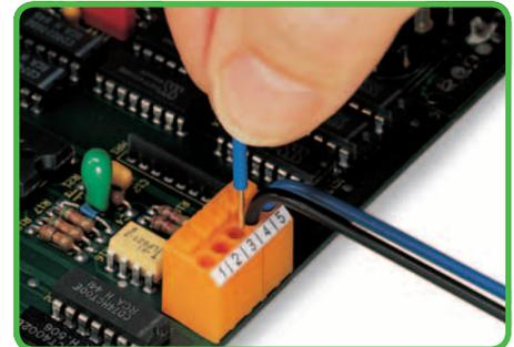
Conector para 0,5 mm<sup>2</sup> – 1,5 mm<sup>2</sup>/AWG 20 – 16 condutores sólidos.
