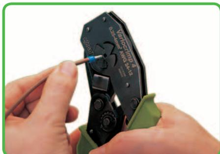
Coloque o condutor com o terminal na unidade de crimpagem. Aperte os punhos até que o mecanismo de travamento seja liberado.
