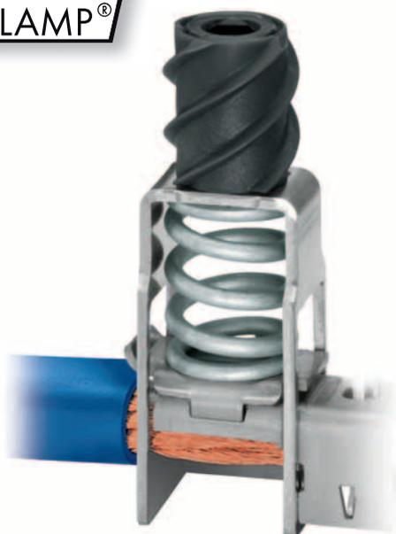
Os POWER CAGE CLAMP® são adequados para todos os tipos de condutores com um corte transversal classificado de 6 a 95 mm<sup>2</sup>. O condutor conectado é fixado em uma gaiola dupla que consiste de uma abraçadeira com fixação por mola e a barra de corrente em formato de U.
