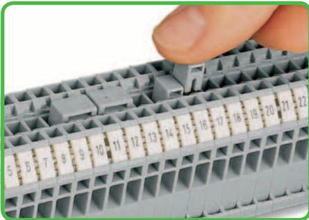
Jumpeamento com jumpers adjacentes. Pressione firmemente o jumper para baixo até que esteja totalmente inserido!
