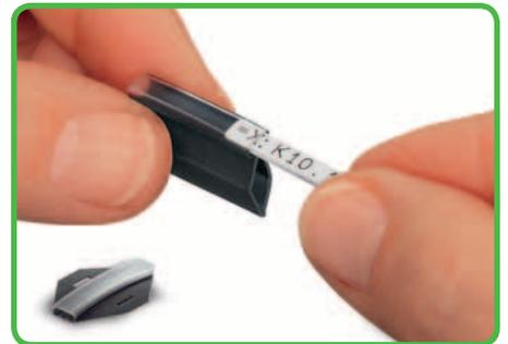
Deslize a cartela plotada ou impresso no suporte da luva de identificação. Também é possível alterar a identificação após o condutor ter sido isolado.
