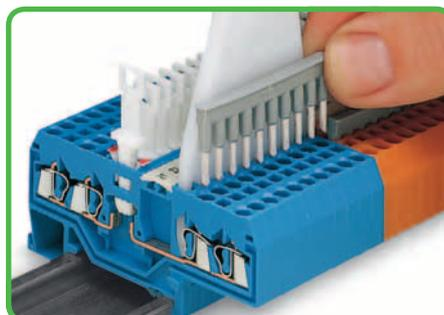
Jumpeamento de bornes de passagem com entrada frontal com jumpers em pente usando uma ferramenta de operação de 10 vias.
