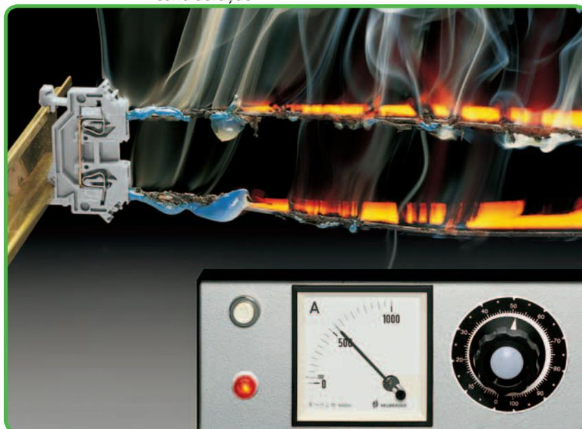
Teste não realístico de um borne CAGE CLAMP® montado em trilho, 12 AWG (4mm<sup>2</sup>): **Aumento da corrente sem limite de tempo.** Em um teste extremo assim (dispositivos de proteção teriam interrompido a corrente), **a conexão elétrica não foi danificada.**
