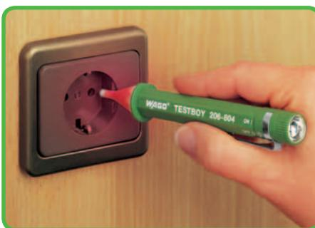
Um dispositivo que detecta de forma confiável tensões AC em cabos, plugs, fusíveis, disjuntores, caixas de conectores e etc.
