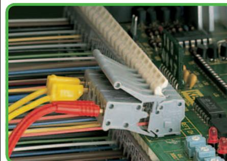
Adaptadores de teste junto ao conector.
