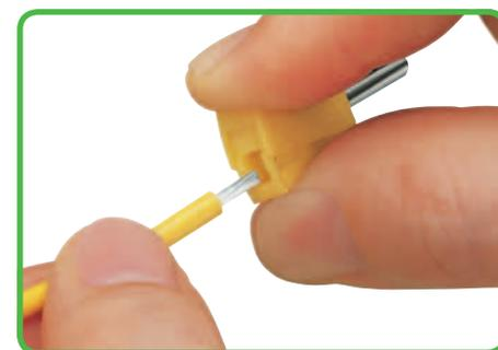
Inserir o Condutor: Pressione totalmente o botão e insira o condutor desengatado na entrada quadrada e em seguida solte.
