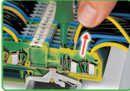
Remoção do conector com chave de fenda.
