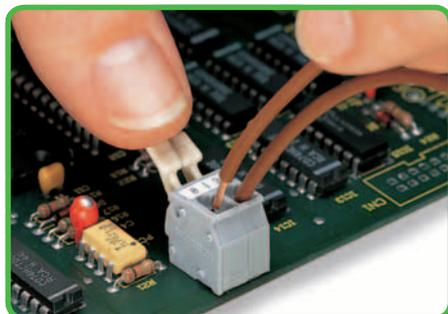
Inserção/remoção de condutores, Linha 255. Operação manual.
