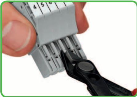
Para codificar um conector fêmea, remova o pino de codificação desejado usando uma ferramenta adequada . . .
