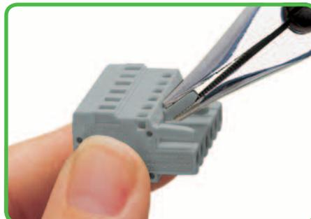
Codificando um conector fêmea – remoção dos fingers de codificação
