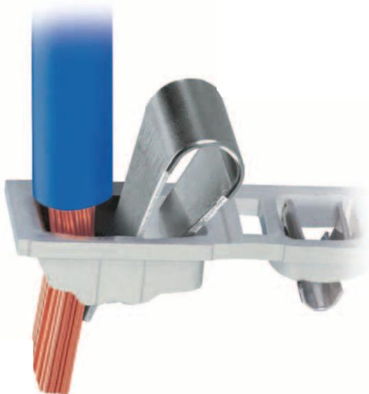
A tecnologia CAGE CLAMP®S oferece a mesma qualidade e recursos para o manuseio que a conexão CAGE CLAMP®, no entanto, com um benefício adicional: fios sólidos e trançados com rigidez suficiente, assim como condutores flexíveis e com terminal crimpado, podem ser diretamente conectados sem nenhuma ferramenta. Isso é obtido, simplesmente empurrando o condutor até que esteja totalmente inserido, sem ter que abrir previamente a unidade de fixação.
