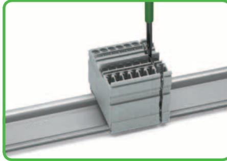
Abra a mola com chave de fenda (3,5 x 0,5 mm / 0,137 x 0,020 pol) e remova o borne através da alavanca.
