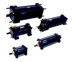
Os cilindros de simples ação são aqueles que utilizam a ação do ar em uma única direção de movimento. São comandados por válvulas de 3 vias e uma de suas principais aplicações é a fixação de peças. Já os cilindros de dupla ação utilizam a energia do ar comprimido nas direções de movimento (avanço e retorno) e são comandados por válvulas de 4 ou 5 vias.
