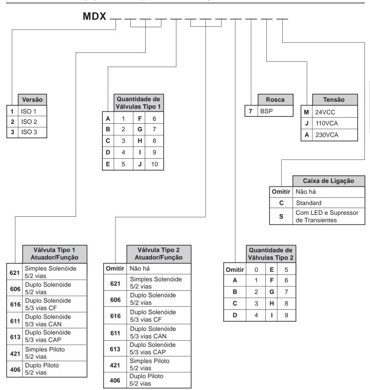
Nota: Quantidade máxima de válvulas (Tipo 1 + Tipo 2) = 10
