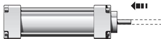
2. Deslocar o sensor ligado até ao ponto de comutação (que é o ponto em que o LED vermelho acende) e marcar sobre o cilindro a posição do canto frontal do sensor.
