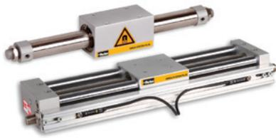
Com a Série de cilindros P1Z é possível obter movimento linear através de um acoplamento magnético entre o carro e o êmbolo, que se desloca devido a pressão pneumática.
