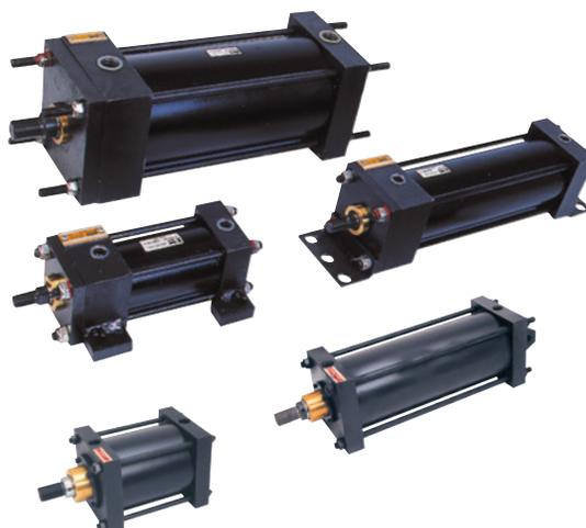
Os cilindros de simples ação são aqueles que utilizam a ação do ar em uma única direção de movimento. São comandados por válvulas de 3 vias e uma de suas principais aplicações é a fixação de peças. Já os cilindros de dupla ação utilizam a energia do ar comprimido nas direções de movimento (avanço e retorno) e são comandados por válvulas de 4 ou 5 vias.
